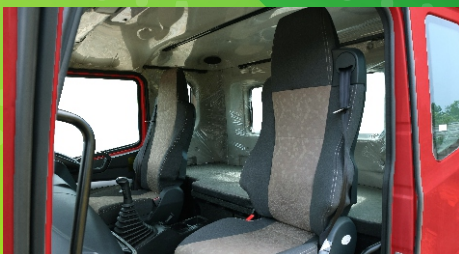
Desain terpadu yang ergonomis dari sabuk pengaman dan kursi menghindari sensasi tercekik pada pengemudi yang disebabkan oleh pengereman darurat
