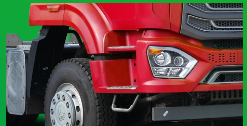
Pedal naik anti selip dan pintu dengan bukaan 90° memudahkan pengemudi untuk masuk ke dalam
